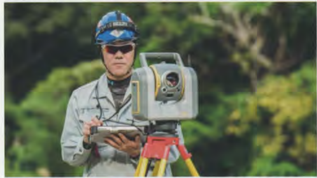
写真-2 3Dレーザースキャナ：Trimble SX10
