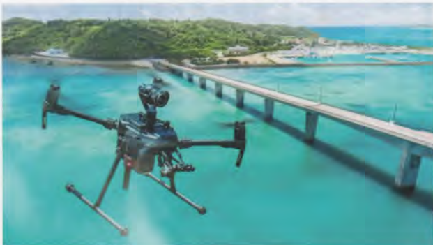
写真-1 DJI Matrice 210 RTKによるドローン空撮状況
